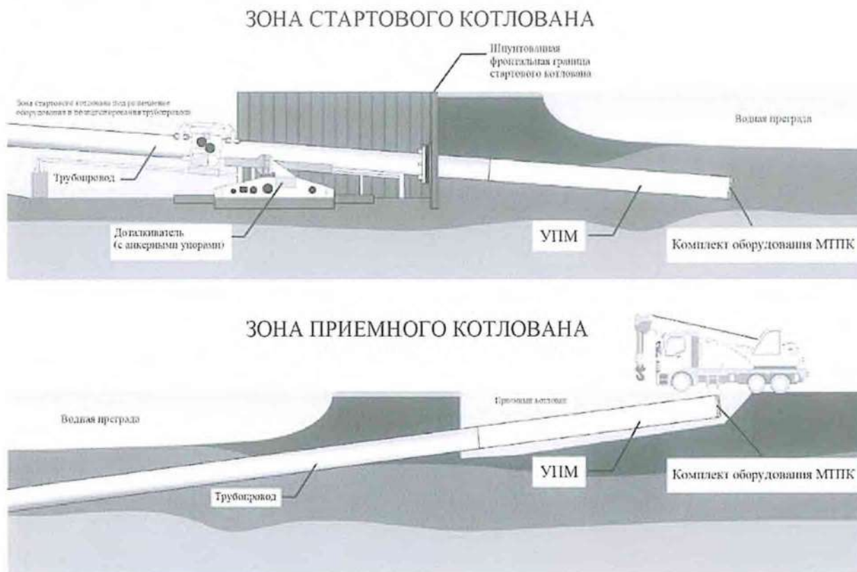
Рисунок 8.7 – Общая схема производства работ по технологии ГНБЦ
