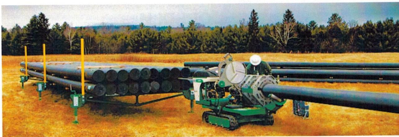
Запатентованная система наведения на осевую линию для равномерного распределения силы вокруг стыка фиксирует трубу в зажимах без особых усилий.
